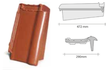
taška okrajová pravá - krycí délka cca: 36,5–40,3 cm - krycí šířka cca: 24,5 cm - hmotnost 1 ks cca: 5,3 kg Spotřeba cca 2,7–2,4 ks/bm délky okrajové hrany.
