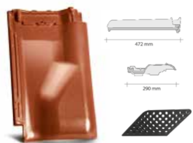
větrací taška - větrací průměr cca: 23 cm 2 - min. požadavek na odvětrání u hřebene je 50 cm 2 /bm - hmotnost 1 ks cca: 4,5 kg Obvykle se větrací tašky pokládají do 2 řady pod hřebenem. Součástí tašky je mřížka do otvoru proti škůdcům.
