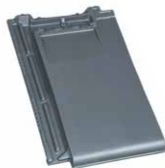
Větrací taška - průřez větracího otvoru 18 cm 2 min.požadavek na odvětrání u hřebene je 50cm 2 /bm
