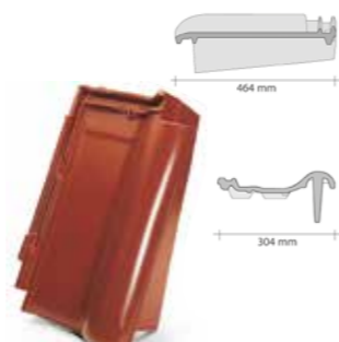
taška okrajová pravá - krycí délka cca: 38,3–40,3 cm - krycí šířka cca: 26,3 cm - hmotnost 1 ks cca: 5,6 kg - spotřeba cca 2,5–2,6 ks/ bm
