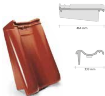
taška okrajová levá - krycí délka cca: 38,3–40,3 cm - krycí šířka cca: 33,9 cm - hmotnost 1 ks cca: 6,4 kg - spotřeba cca 2,5–2,6 ks/ bm
